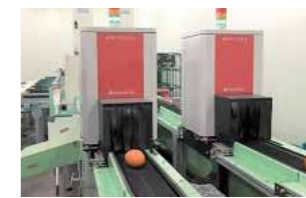
果実に光を当て、外見だけではわからない中身の品質を1個1個チェックすることができます
