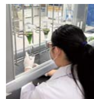
残留農薬検査での前処理の様子。検査結果は産地へフィードバックします
