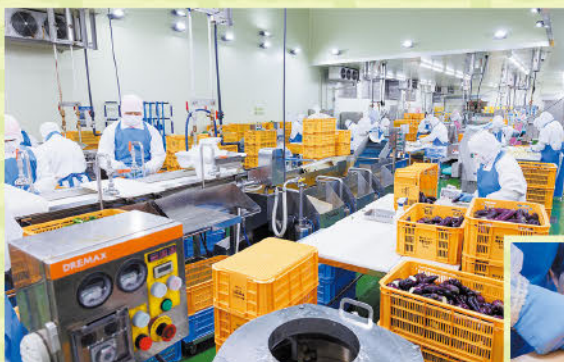
工場では豊富な地下水をくみ上げて野菜を洗浄。3〜4℃に冷却したものを使用し、野菜の鮮度を保っています
