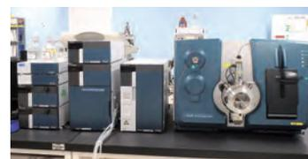
残留農薬検査の分析機器 LC/MS/MS
